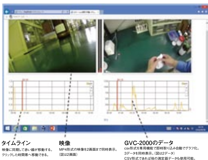
図2. VEMシステムの使用例 (左画面:通常、右画面:エタノールふき取りモデル作業時のばく露)
