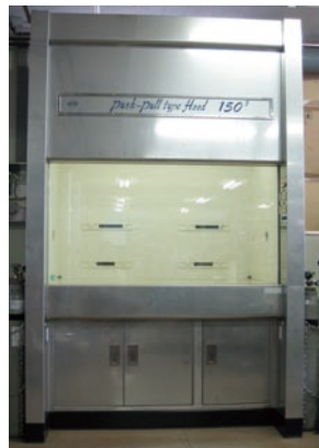
写真1 エアシールドフード全景
