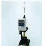
ホルムアルデヒド用電動吸引式検知管 (No.91P, 91PL)と 自動ガス採取装置GSP-300FT-2
