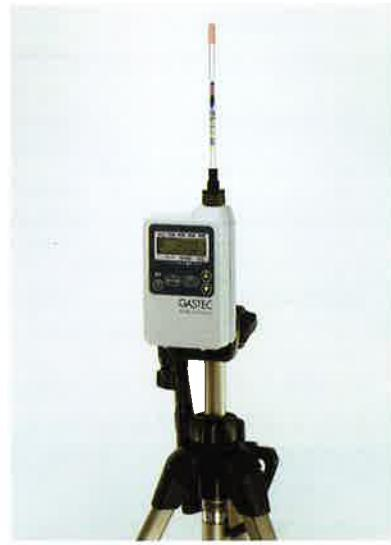
本検知管は、電動吸引ポンプを使用しサンプリングする連続吸引式の検知管です。
