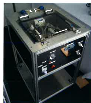
図4 高精度型低濃度校正ガス発生装置
