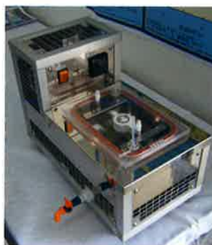
図3 簡易型低濃度校正ガス発生装置
