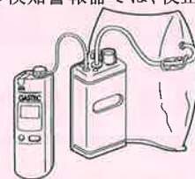
ガス校正キットCK-2を用いたガス検知警報器の校正
