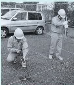
君津式表層汚染調査法（イメージ） ボーリングバーによる穿孔（右方） 検知管による測定（左方）
