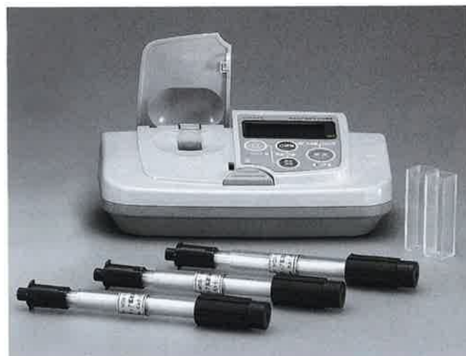
携帯形LED比色計とミニチュア拡散スクラバー捕集管
