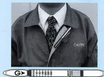
拡散形トルエン検知管の構造と装着
