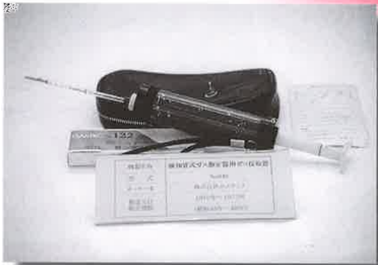
ガステック創立時の検知管用ガス採取器です。ボディ以外は、当時としては珍しいプラスチック成形品。軽くて使い易く、好評でしたが、いささか耐久性に欠けるのが欠点でした。
