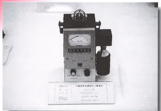
創立した翌年から製造を始めた可搬形の酸素濃度指示警報計。徹夜で製造しても間に合わなかった懐かしい思い入れのある製品です。
