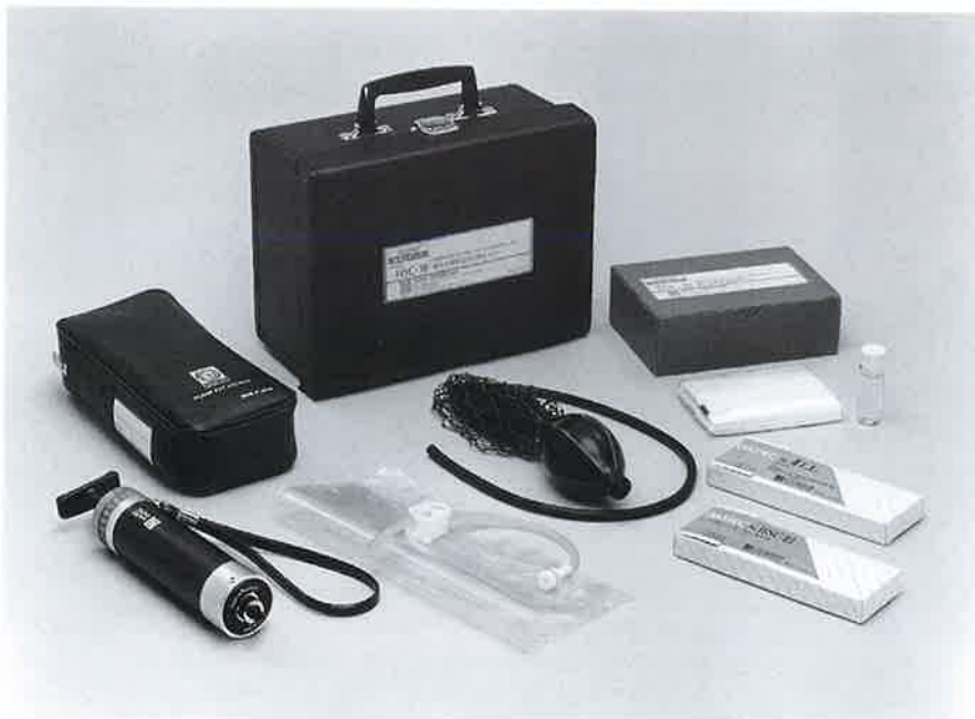
硫化水素校正ガス発生キット HSC-10
