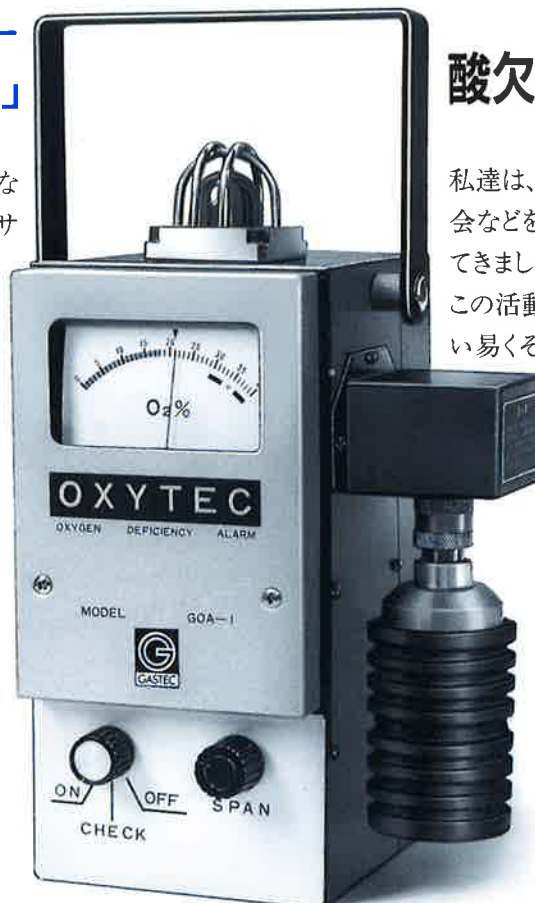
今も現役で活躍中の OXYTEC酸素計(昭和46年)第一号機GOA-1型
