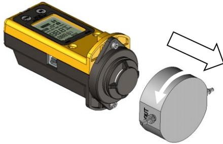
校正用チャンバーを測定器本体から取り外します。軽く回すように外すと容易に取り外せます。
