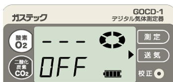
電源が切れる前の送気状態
