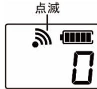
積算濃度を表示している時だけ、警報ランプ、ブザー、振動モーターを「停止」することができます。積算濃度表示から現在濃度に戻ってしまった時は、「電源」スイッチを短く 3 回押して、積算濃度表示に切り替えると警報を「停止」することができるようになります。
