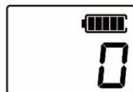
電源を入れたときに電池残量が少なく電池マークが 1 つになった場合は、電池残量注意表示「b.ch」を 2 秒間表示し、ブザーが鳴ります。その後、現在濃度と電池残量が表示されます。この場合、予備の電池をご準備して、ご使用ください。
