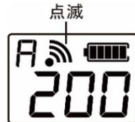
積算濃度は、現在濃度が下がっても、増加しなくなるだけで下がることはありません。積算濃度警報を「停止」しない場合は、警報ランプ、ブザー、振動モーターは電源を切るまで、動作し続けます。
