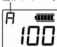
③「電源」スイッチを短く押すと、動作モードマークが「C」になり校正ガス濃度が表示されます。(4 秒以上押すと、電源が切れます。)
