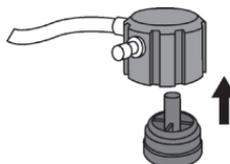
※チャンバアダプタの先端が校正用ガスチャンバに当たるまでしっかり押し込みます。
