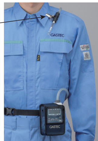
呼吸域に装着 <一例> <腰部の自動ガス採取装置にチューブで接続>
