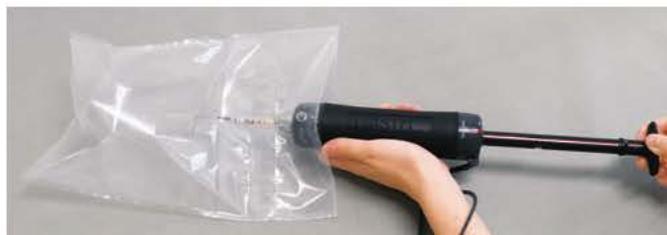
採取袋に吹き込んだ呼気試料の検知管(No.112AC)による測定
