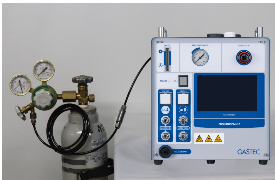
*高圧ガス容器接続の一例
