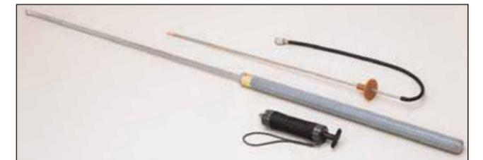
ボーリングバー (No.361) 地下浸透用延長採取管 (No.360)
