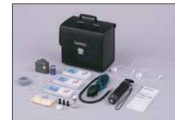
信頼性の高い測定を行うには校正用ガスを用いたスパン校正が必要となります。校正には専用の校正用硫化水素発生キットを使いガスを発生させて行います。正確な測定を行うにはセンサの測定範囲にあった校正ガスを必要があります。
