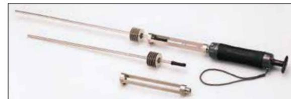
高温ガスを冷却し正確測定。
