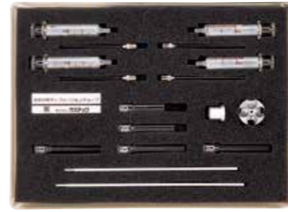
多成分用ディフュージョンチューブ No.3200 シンナー等溶剤は多成分の物質を含んでいます。従来の方法では、単成分の校正用ガスしか調製できませんでしたが、多成分用ディフュージョンチューブにより、同時に4種類の校正用ガスを調製することが可能です。この結果、分析作業の効率化ができます。
