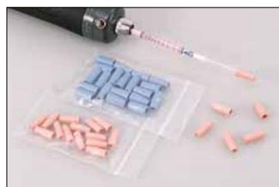
万が一のケガを防止するため、検知管の先端に取り付けるゴム管で、繰り返し使用できます。一番太い(外径7mm)検知管には青色を、それ以外にはピンク色をご使用ください。20個入り1袋。
