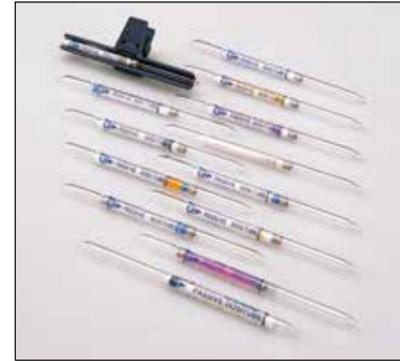
パッシブ・ドジチューブは、長時間の平均ガス濃度を測定するものでガスの自然拡散を利用しています。一定内径のガラス管の中にディフューザ\* (拡散誘導体) を検知剤と平行に挿入することにより、ガスの拡散を容易・一定にする機能を持ち、高感度でシャープな変色層を作ります。
