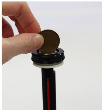
⑧気体採取器の気密性の点検を行い、気密性が良好であることを確認します。
