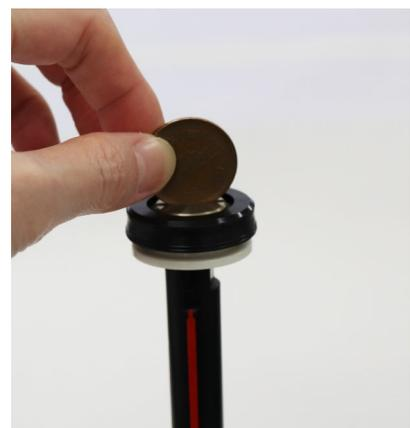
②固定ねじ、ピストン、フランジを取り外します。
