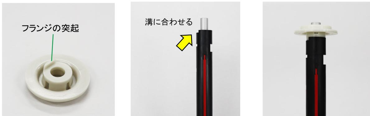
⑥フランジの4箇所（溝）にピストンの4箇所（突起）が合うように、ピストンを取り付けます。
