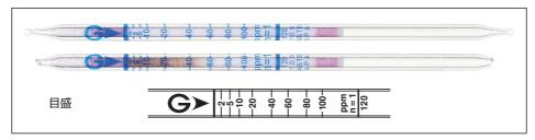
仕 様 作業環境測定で主成分がトルエン、キシレン等の混合有機溶剤を測定可能。 この検知管はトルエンで校正しています。
