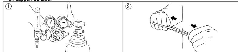
3. Fixez le support de tube en caoutchouc à la sortie du débitmètre. Veillez à ce que la flèche (G) du tube soit dirigée vers le bas.
