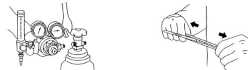
3. Fixez le support de tube en caoutchouc à la sortie du débitmètre. Veillez à ce que la flèche (G) du tube soit dirigée vers le bas.
