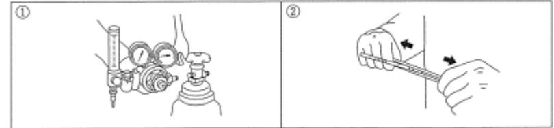
3. Befestigen Sie den Gummihöhrchenhalter am Durchflussmesserauslass. Achten Sie darauf, dass der Pfeil (G) auf dem Röhrchen nach unten zeigt.
