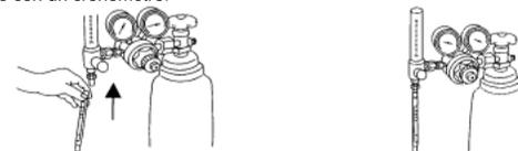
6. Tan pronto como finalice el tiempo de muestreo, desactive el cilindro o el compresor, extraiga el tubo del portatubo y, a continuación, lea inmediatamente la capa de color cambiada.
