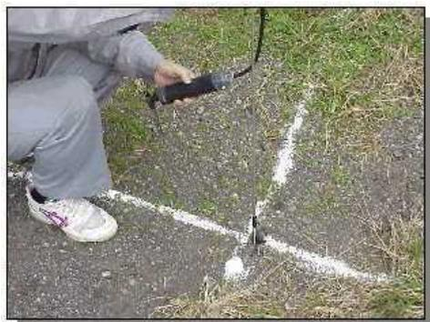
取管の先端に両端を折った検知管を取り付ける。
