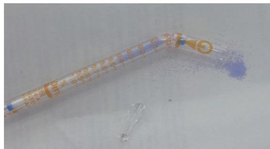
検知管が割れた時は、ガラスの破片、検知剤、除去剤に素手で触れないで下さい。素手で触れると、けがなどをする恐れがあります。検知剤、除去剤に触れてしまった時は、直ちに水でよく洗い流して下さい。ガラスの破片や検知剤、除去剤は掃き取り、さらに水を含んだ濡れ雑きんで拭き取って下さい。酸素検知管31Eが割れて、もし検知剤が飛散した時は、白煙(塩化水素)が発生しますので、塩化水素を吸い込まないで下さい。吸い込むと目、鼻の痛み・せき込む等の恐れがあります。塩化水素を吸い込んだ場合は、直ちにうがいをし、さらに目、鼻を水でよく洗い流した後、すみやかに医師の診断を受けて下さい。
